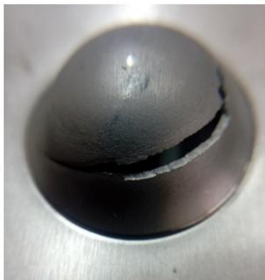
Рисунок 3. Вид образца жаропрочного сплава после испытания по Эриксену
